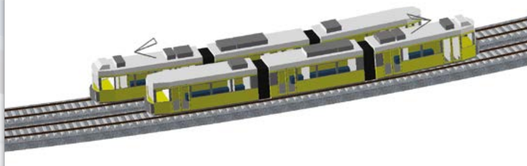
Bild 4: BIM mit GEOPAC für ELITECAD – Schottergleis mit GT6N-Begegnungsverkehr in 3D.
