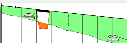
Kompromisslösung: querende Straße in einer Einschnittlage.
