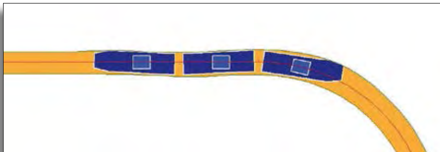
Abb. 1: Wagenkette und Drehgestellanordnung des Fahrzeugs „GT6N“ aus Berlin bei Einfahrt von einer Geraden in einen Kreisbogen r=18 .
